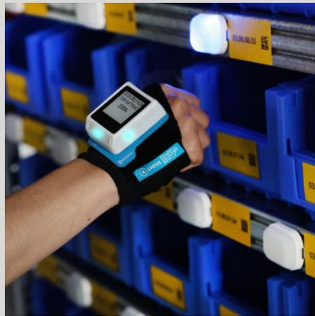
**EASY PAIRING** - das LIGHT TAG und der entsprechende Lagerplatz werden gescannt und schließlich gepairt
